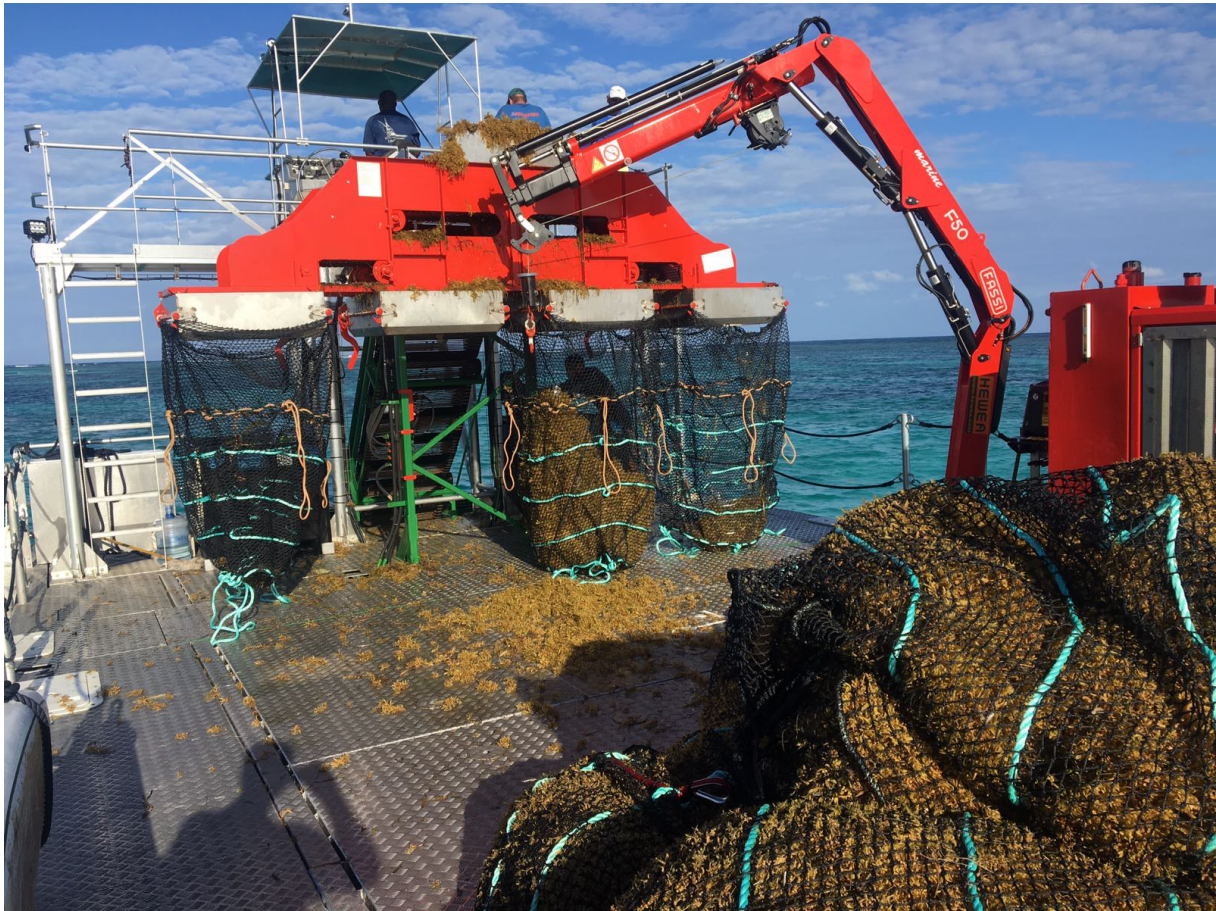
Les barges permettent le ramassage de 700 m 3 /jour, soit environ 200 tonnes par jour
